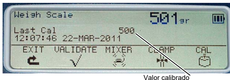
Figura 8. Balanza de peso: Fecha, hora, último valor de calibración
