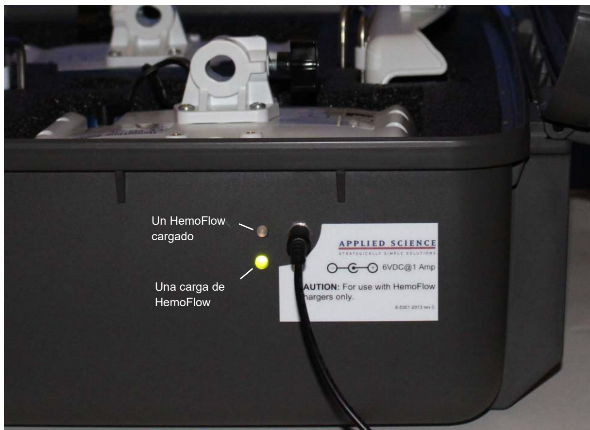
Figura 4. LEDs de estado de carga
